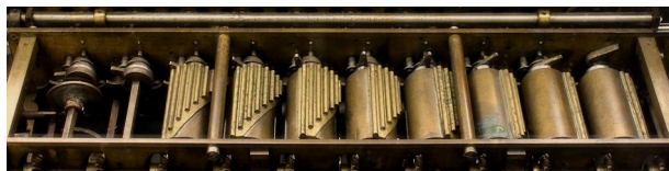
L'interno del Delton, una calcolatrice a 8 cilindri, uno per ogni cifra dell'operando
