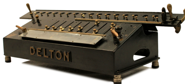
Il Delton del Museo degli Strumenti per il Calcolo, un aritmometro prodotto in Austria ai primi del 1900
